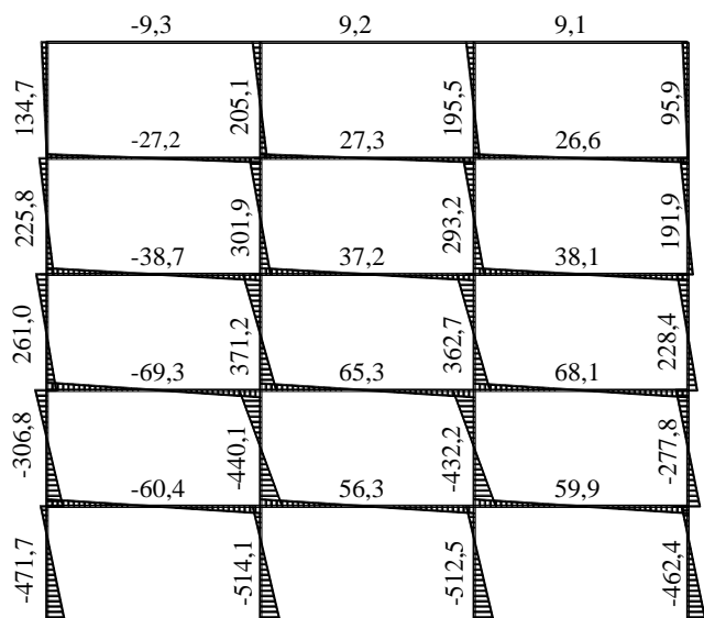
Д.12 – сурет. Сейсмикалық күштерден иілу моменттерінің M_{Ed,E,y} эпюрасы (Б қатары)
