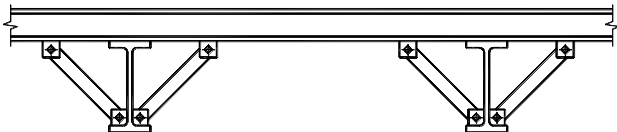
Рисунок 2.14 – Типовое жесткое закрепление от кручения
